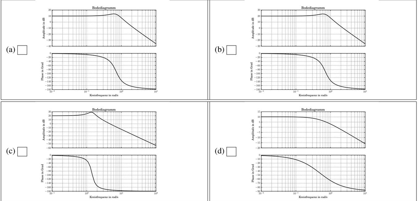
9. Welches System wird durch die Übertragungsfunktion  $G(s) = \frac{6s^2-s-2}{s^2-7s+6}$  beschrieben?
